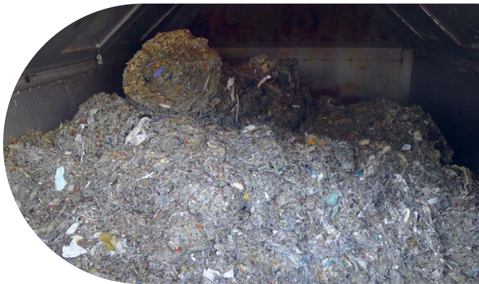
Skratki — odpady stałe oddzielone na kratkach mechanicznych
